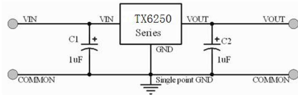
Note1:Input capacitor  $C_{IN}=1\mu F$ .
