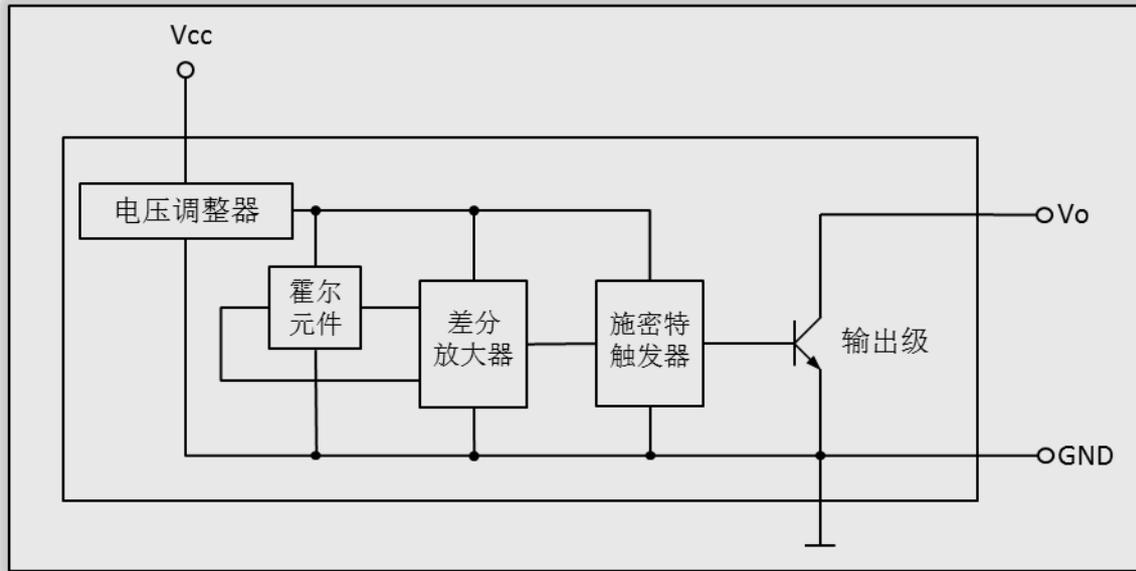
AH3144 霍尔传感器是一种以单磁极激励的单端数字输出霍尔集成电路。传感器芯片内置有反向电压保护器、电压调整器、温度补偿电路、霍尔电压发生器、信号放大器、史密特触发器和集电极开路输出驱动器等电路单元。性能优良的电压调整器和温度补偿电路，确保传感器在较宽的电压范围和温度范围内稳定地工作，反向电压保护电路避免了传感器受到反向电压的损伤。
